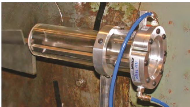
Dysza toroidalna „Standard” zdmuchuje chłodziwo z części i cofa je do centrum obróbczego.
