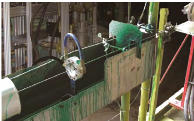
Dysza pierścieniowa „Standard” model 2431 1” (24 mm) zdmuchuje nadmiar powłoki z drutu do zbiornika zanurzeniowego.
