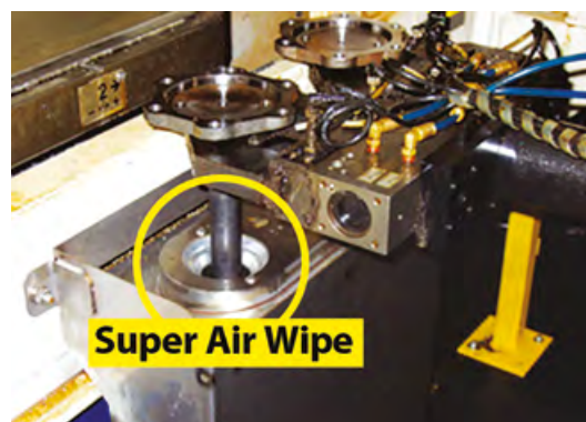
Kołnierzowy koniec osi jest podnoszony przez otwór w dyszy pierścieniowej „Super” w celu zdmuchnięcia wiórów po obróbce.
