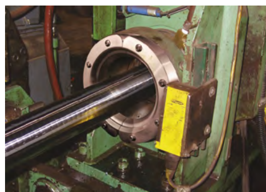
Dysza pierścieniowa „Super” model 2404 4" (102 mm) oczyszcza pręt stalowy po obróbce.
