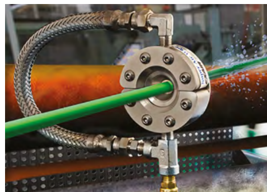
Dysza pierścieniowa „Super” 1/2" ze stali nierdzewnej jest idealna do suszenia przewodów, rur, światłowodów, kabli i innych wyrobów o małej średnicy.
