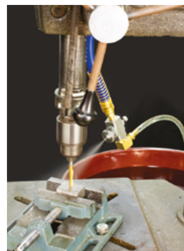
Dysza rozpylająca zasilana lewarem o strumieniu okrągłym model SR1010SS jest używana do doprowadzania mgły chłodzącej do operacji wiercenia.
