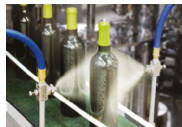
2 dysze rozpylające z mieszaniem zewnętrznym o szerokokątnym strumieniu płaskim model EB1030SS są używane do końcowego płukania dezynfekującego przed etykietowaniem butelek wina.
