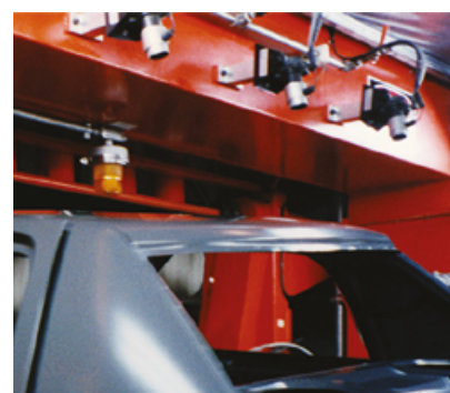
3 działa jonizujące zdmuchują zanieczyszczenia z karoserii samochodowych przed malowaniem.
