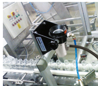
System działa jonizującego model 8292 eliminuje ładunki elektrostatyczne i pył przed napełnianiem butelek.
