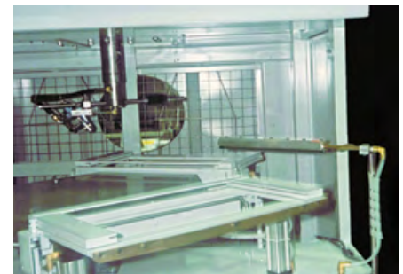
System noża powietrznego jonizującego „Standard” model 8212 (305 mm) czyści ramy metalowe przed malowaniem proszkowym.
