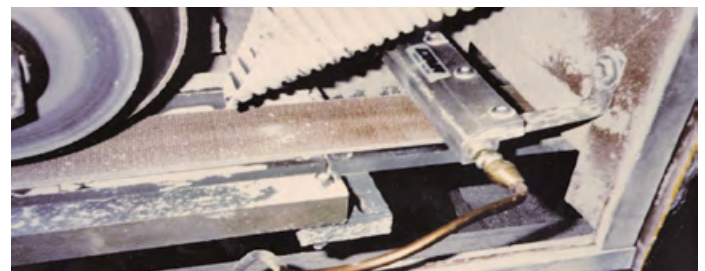
Nóż powietrzny „Standard” model 2006 6” (152mm) zdmuchuje proszek z taśmy tak, aby można go było odkurzyć.
