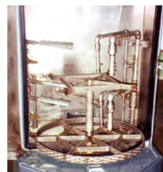
3 noże powietrzne „Standard” model 2012 12” (305 mm) wykonują cykl suszenia w myjce części.
