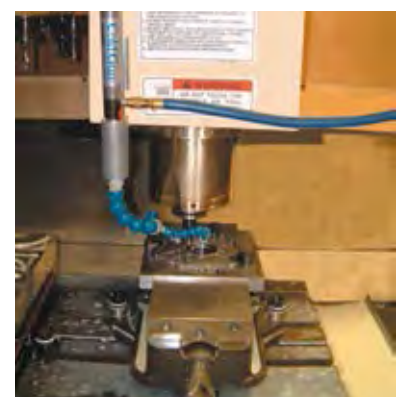
Pistolet chłodzący model 5315 chłodzi frez 2-ostrzowy z węglików spiekanych 3/8" w obrabiarce CNC, zwiększając żywotność narzędzia o 50%.
