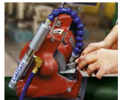
Zimne powietrze eliminuje pęknięcie narzędzi podczas ostrzenia.
