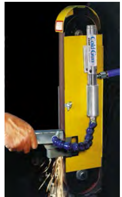
Cold Gun 5215 utrzymuje niską temperaturę części i zapobiega odbarwieniom.
