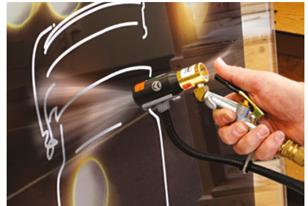
Pistolet jonizujący model 8293 czyści prace artystyczne i szkło przed obramowaniem.
