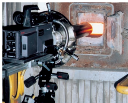
Specjalne dysze chłodzące do wysokich temperatur chłodzą soczewki horoskopu umieszczone w kotle o temperaturze 648,89^{\circ}\text{C} .
