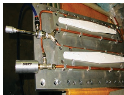
Vortex Tube 3225 chłodzi plastikowe części zmywarki do naczyń podczas spawania ultradźwiękowego.
