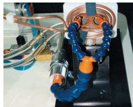
Vortex Tube 3215 chłodzi matrycę na maszynie do formowania rurek medycznych.
