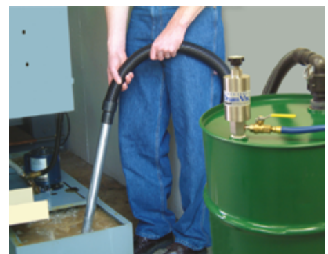
System dwufunkcyjnej pompy beczkowej o pojemności 114 l model 6196-30 opróżnia zbiornik chłodziwa obrabiarki CNC.
