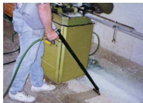
System do odkurzania pistoletu Vac-U Gun z workiem zbiera adsorbent i wióry.
