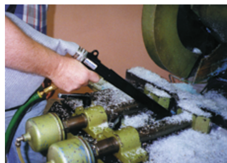
System uniwersalny pistoletu Vac-U Gun usuwa strużyny tworzywa sztucznego z piły.
